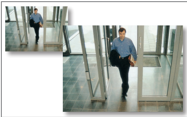
Barrido entrelazado, 20 ms de diferencia entre líneas pares y líneas impares
